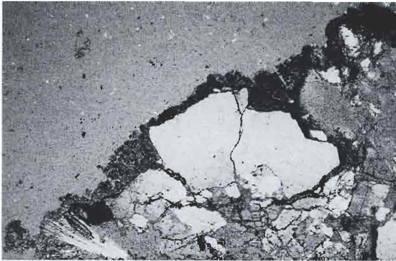
Figura 6: Visió al microscopi òptic de la pàtina de matèria orgànica que recobreix parcialment la pedra i que produeix la disgregació de la pedra en penetrar, com s'observa a la fotografia, per les interfases minerals. A la banda inferior esquerra de la fotografia s'observa també l'expansió que presenten els plans d'exfoliació de les biotites superficials en patir hidròlisi.
